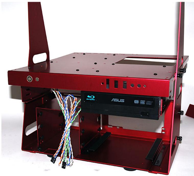
Una volta assemblata la parte frontale è possibile accedere alle predisposizioni per le due unità da 5 pollici e 1/4; nell'immagine vediamo un lettore Blu-ray, montato immediatamente sopra l'area riservata all'alimentatore ATX. Sul lato di sinistra è previsto il cassetto per 3 hard disk da 3 pollici e 1/2, dietro al quale sono presenti le due staffe con le quali installare due unità di storage da 2 pollici e mezzo.
